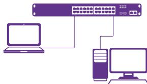
Соедините порт коммутатора с сетевой картой ПК, подключите питание к коммутатору. Настройте на сетевой карте ПК IP-адрес из диапазона 192.168.1.2-254, например 192.168.1.100. Подключитесь к IP 192.168.1.1 по протоколу Telnet.
